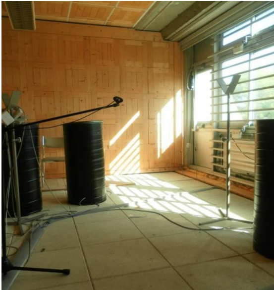
Essais acoustiques des ouvertures vitrées
