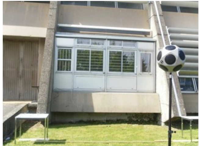
Essais acoustiques des ouvertures vitrées
